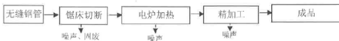
图 2-3 下导磁环生产工艺及污染流程图
