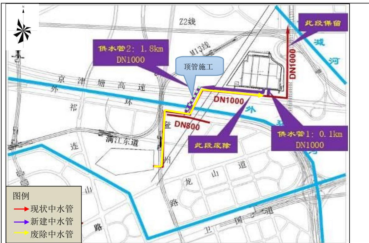
图 1-3 中水输出管线示意图
