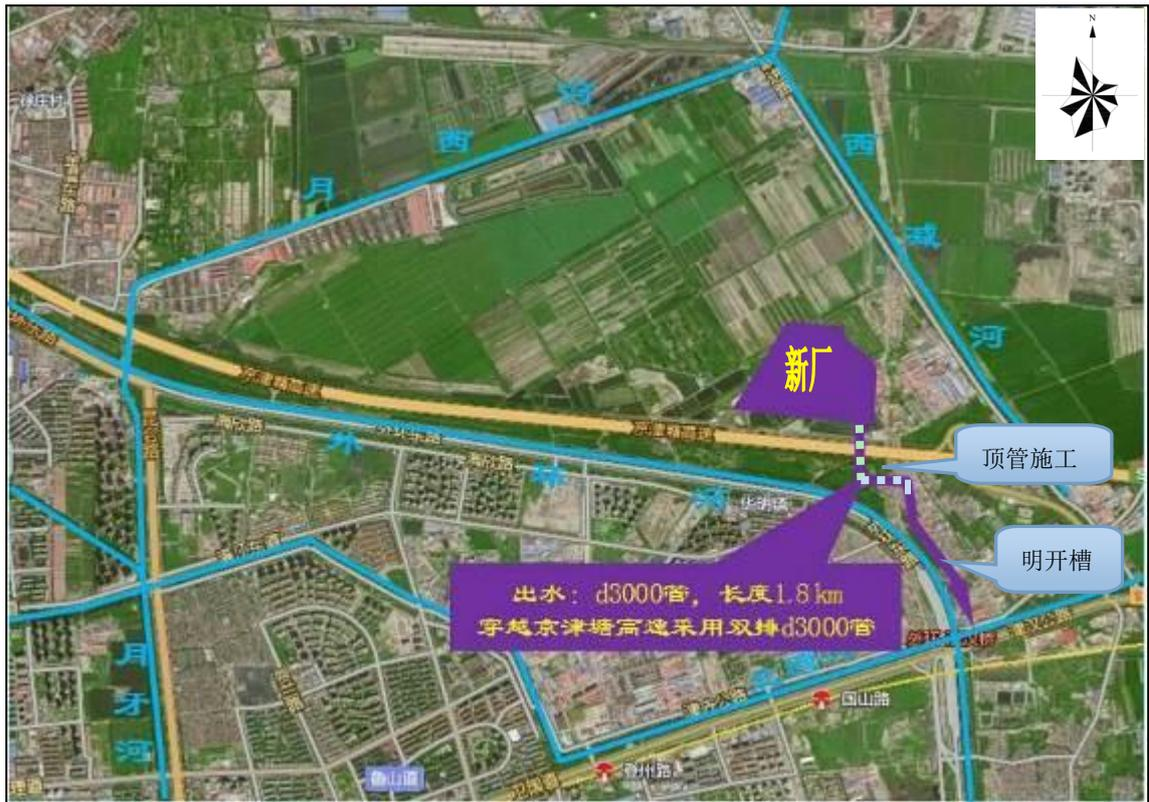
图 1-2 污水输出管线示意图
