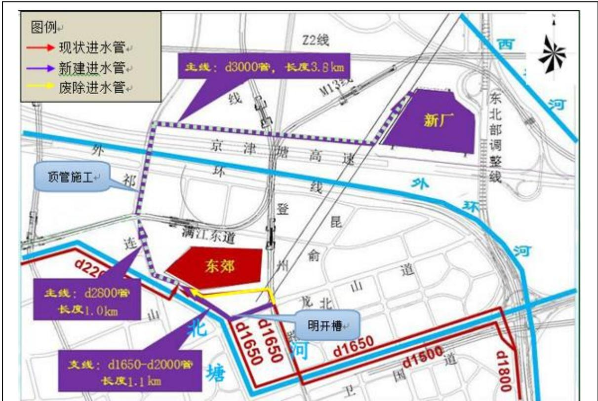
图 1-1 进水管线示意图
